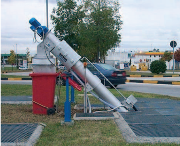
ROTAMAT® Ro 9 ruuvivälppä asennettu keskelle kiertoliittymää
